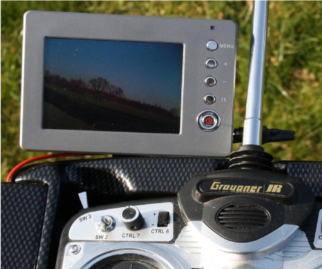
Wenn ein Videosender an die Kamera angeschlossen wird, kann das Videobild live zum Boden gesendet werden. (Handelsübliche 2,4GHz Videosender)
